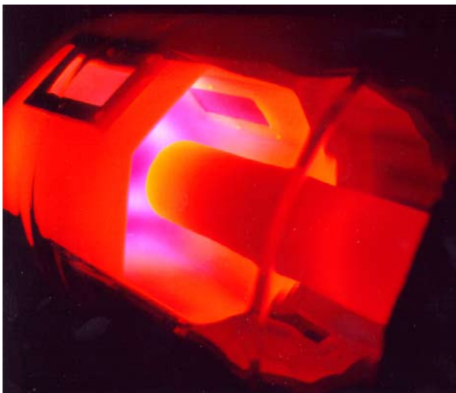
Prototype de brûleur premix à très faibles émissions de NOx réalisé par OWI dans le cadre d'un projet subventionné par IWO.
