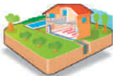
Pompe à chaleur sol-eau
